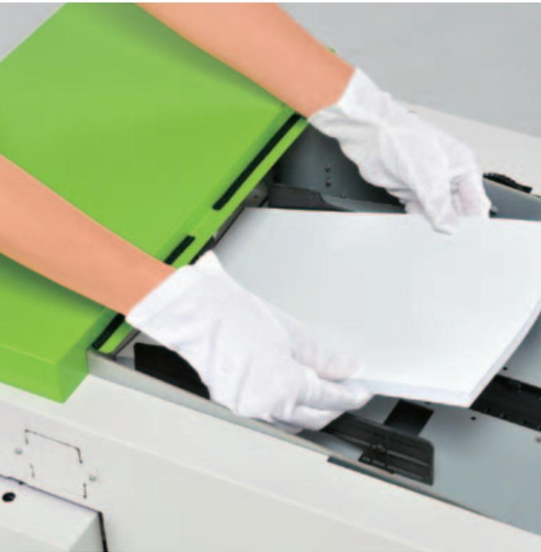
► Stück für Stück: Die Einzelblattablaage am Einzelblatteinzug nimmt, abhängig von der Papierstärke, bis zu 157 Bogen auf. *Abb.: NK Works Co., Ltd.*
