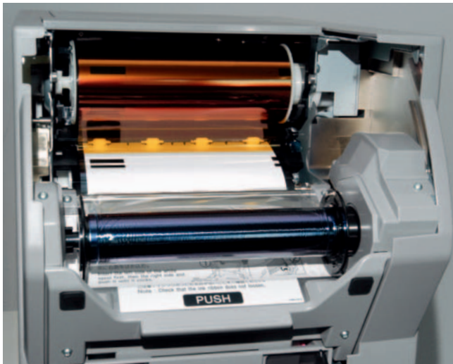
► Eingesetzt: Fester Bestandteil des Farbbandes (hinten) ist der Leerkern (vorn), der die verbrauchte Farbfolie aufnimmt. Unter den beiden Rollen befindet sich das Papier (M.).
